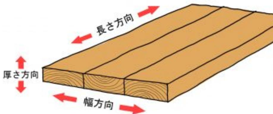
「幅はぎ」＝幅方向に接ぎ合せた板
